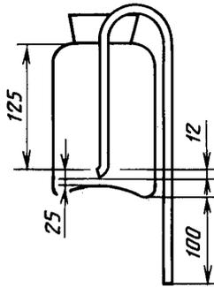
Сосуд в третий раз доливают водой до того же уровня, смесь перемешивают палочкой и дают отстояться 5 мин. Затем вновь сливают воду. Отмучивание повторяют до тех пор, пока вода в сосуде после 5-минутного отстаивания не станет прозрачной. Осадок из сосуда количественно переносят на фильтр или в фарфоровую чашу. В фарфоровой чаше отстаивают в течение 5 мин, воду сливают, осадок высушивают при 105—110 °С до постоянной массы и взвешивают.
